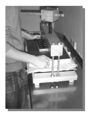
.....und die Presse zugedreht. Wichtig: Die Spindel muss in die Aussparung in der Abdeckplatte gedreht werden. Wenn die Presse fest zugedreht ist 10 Minuten abwarten. Anschließend wird die Presse wieder aufgedreht, die Abdeckplatte abgenommen und die Grundplatte mit Filzen und Blättern auf den Tisch gestellt.
